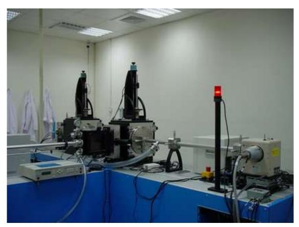
儀器中文名稱:高解析度小角度光散射儀
